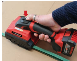
Tensionamento tramite pulsante Tensioning by button
