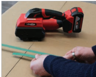
Inserimento reggetta con Typhoon HP Strap insertion with Typhoon HP
